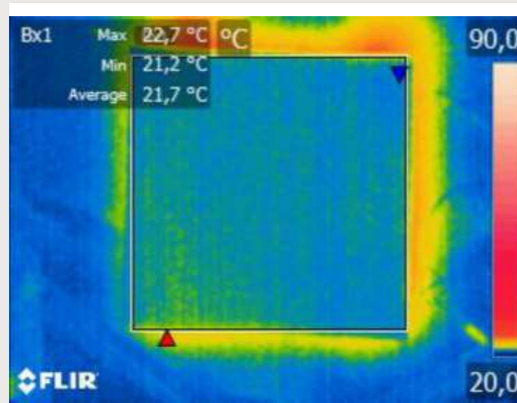
Próbka z izolacją styropianową
